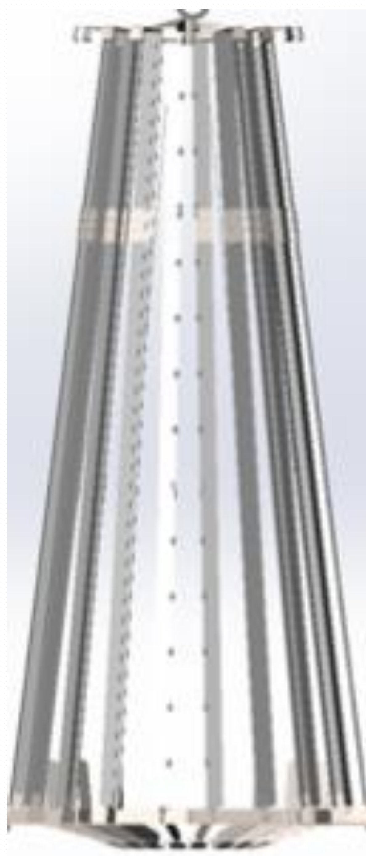
Figure 1. Structure à hydrophones (fermée).
